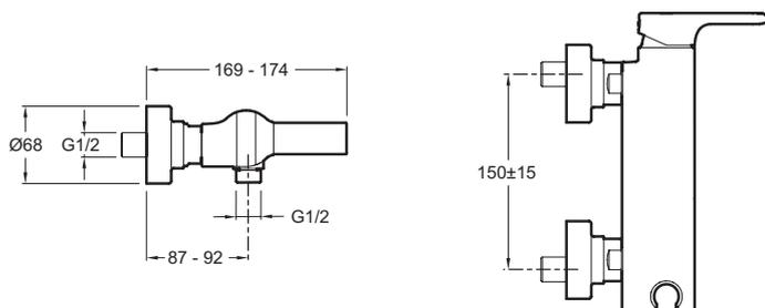
Спецификация продукта: Настенный смеситель для душа. E10869. Коллекция: SINGULIER. Вес: 3,1 кг. Расход воды: 13 л/мин при давлении 3 бар. Механизм: Последовательный керамический картридж. Разметка отверстий:  $150 \pm 15$  мм.
