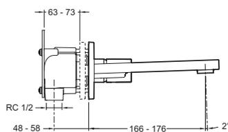
Спецификация продукта: Настенный встраиваемый смеситель для умывальника, управление ручкой. E73061. Коллекция: COMPOSED. Размеры (см): х х см. Вес: 4,5 кг. Тип установки: Крепление к стене. Нормы и правила: ACS : 14ACCLY511. Расход воды: Максимум 5 л/мин.. Расстояние между центром излива и центральной осью корпуса: 166 - 176 мм. Механизм: Керамический картридж. Управление ручкой. Без донного клапана.
