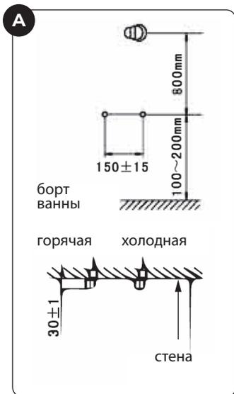
1. Трубы с горячей и холодной водой должны располагаться на расстоянии 150 мм друг от друга по центрам. Рекомендуемая высота от борта ванны до места подключения смесителя 100-200 мм (рис. А).
