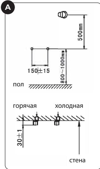
1. Трубы с горячей и холодной водой должны располагаться на расстоянии 150 мм друг от друга по центрам. Рекомендуемая высота от пола до места подключения смесителя 800 - 1000 мм (рис. А).
