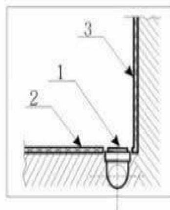
А - Вывод канализации устраивается в уровень с полом из стены или из пола под срез кафельной плитки.
