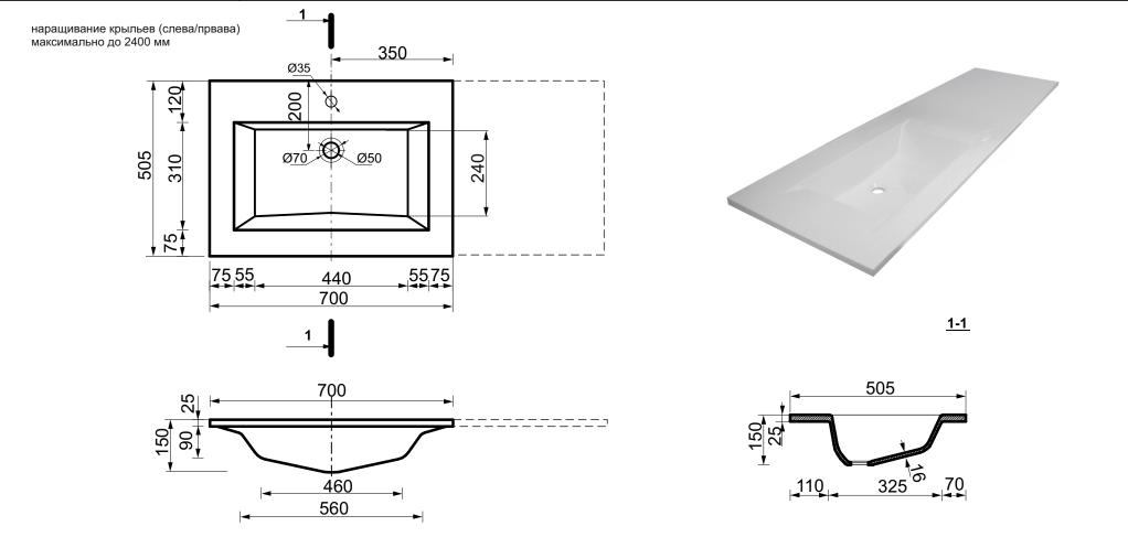
ПРОИЗВОДСТВО ИЗДЕЛИЙ ИЗ ЛИТЬЕВОГО МРАМОРА \*Допустимое отклонение линейных размеров ± 5мм
